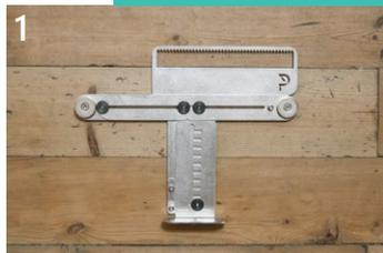
Fixez le support vertical dans la glissière de l'axe horizontal à l'aide des deux écrous supérieurs
